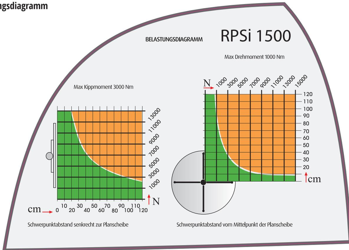
Alle Drehtische der verschiedenen Belastungsklassen besitzen Belastungstabellen. In den Tabellen sind die größten zugelassenen Drehmomente und Kippmomente ersichtlich. Der Aufkleber mit den Tabellen befindet sich am Gestell des Drehtisches. In der Tabelle ist horizontal die Entfernung (cm) und vertikal die Last (N) dargestellt. Die Belastung darf nicht außerhalb der zugelassenen Zone liegen.
